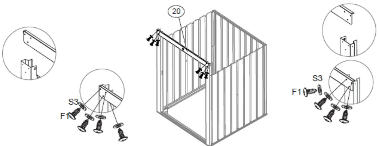
⑬ Befestigen Sie die vordere Wandverstärkung (20) mit der linken (4L) und der rechten Türschiene (4R). Verwenden Sie dafür die Schrauben (F1) und die Unterlegscheiben (S3).
