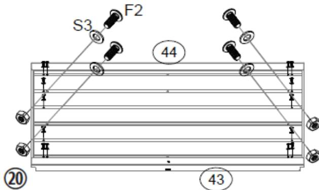
Setzen Sie die obere und untere Türverkleidung aus Schritt 18 auf die fertige Türverkleidung und fixieren Sie diese mit den Schrauben inkl. Mutter (F2) und den Unterlegscheiben (S3).
