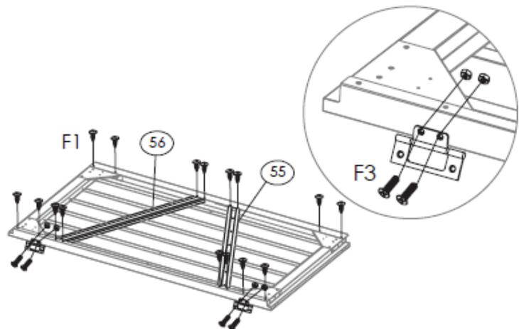
Montieren Sie nun die Türscharniere (G4) mit Schrauben inkl. Mutter (F3) an der Außenseite des Türflügels (D1).
