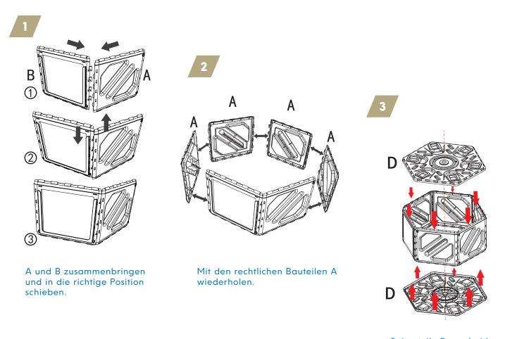
Seitenteile D von beiden Seiten außen anbringen.
