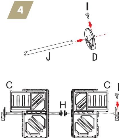
Sicherstellen, dass sich die Bauteile C nach außen öffnen, wenn die Kammern verbunden werden.
